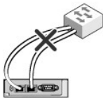
Abbildung 2-3. Inkorrekte Verkabelung für CMC-Netzwerkverbindung - 1 CMC
